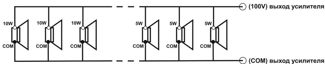
В трансляционных линиях все акустические системы должны быть соединены параллельно. При этом суммарная мощность всех громкоговорителей в цепи не должна превышать регламентированную мощность усилителя. **!! Используйте CVGaudio WPA10T только с усилителями имеющими высоковольтный 100V трансляционный спикерный выход !!**
